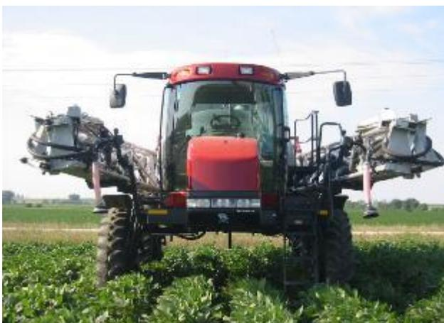
**Figura 47: Pulverizadora con el botalón plegado**
