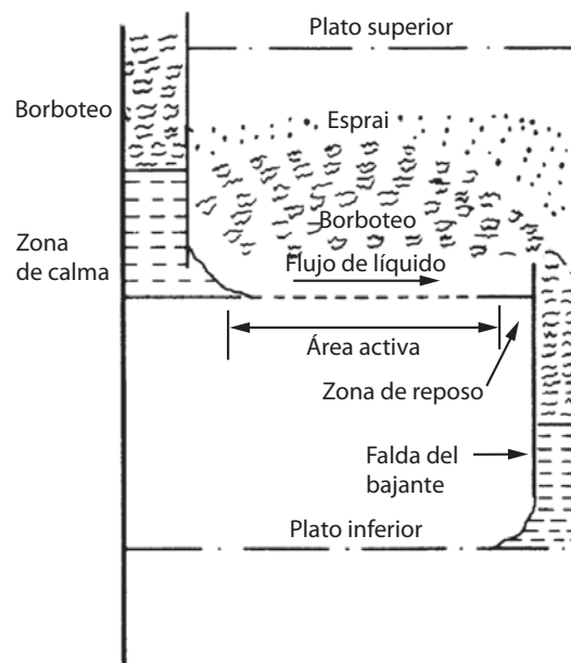
Figura 11.23. Plato de circulación cruzada típico (tamiz).
