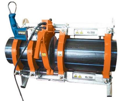
**Nota:** la temperatura de la placa, las presiones y los tiempos indicados en los puntos 5 y 6, están dados por el fabricante de la maquina según el SDR del tubo.
