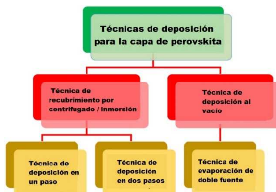
Figura 3 - Distintas formas de deposición para fabricación de PSC [4].
