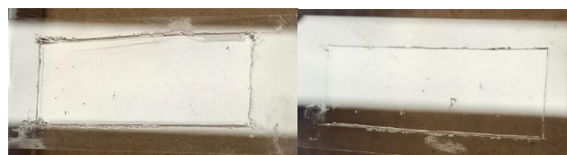
Figura 1. Izq. Recubrimiento vitrimérico en etapa termoplástica. Der. Recubrimiento en etapa correspondiente a red entrecruzada. Se utilizó la técnica de drop casting.
