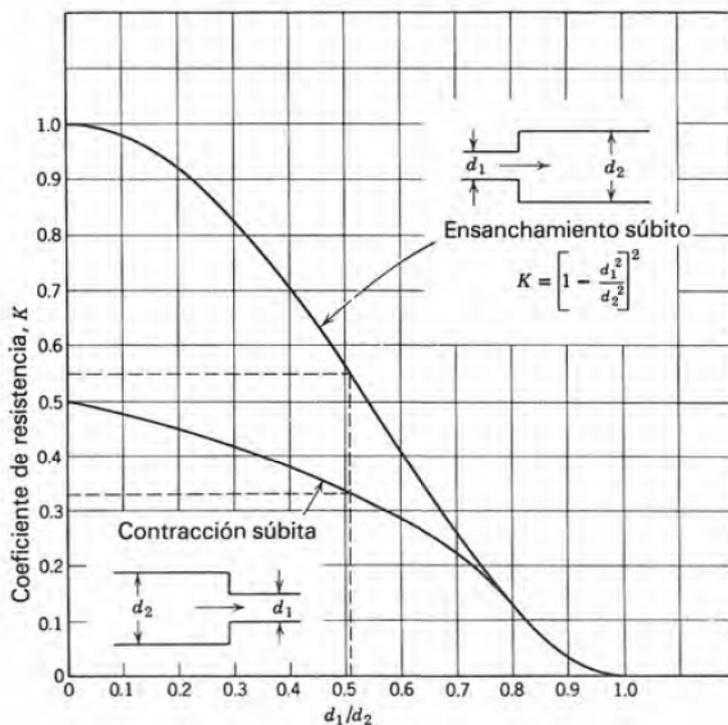
Para diversos ensanchamientos y contracciones súbitas, se lee el valor  $K$  para la geometría apropiada y se utiliza como parámetro en el Apéndice C-2d con el tamaño del tubo, para deter-
