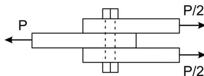
SI  $P = 31000$  lb y el esfuerzo cortante en los pernos no debe exceder de  $10000$  lb/pulg<sup>2</sup>.
