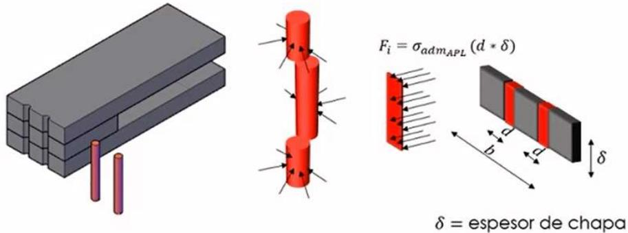
Se considera el área de aplastamiento igual al espesor de la chapa por el diámetro del bulón (proyección de la superficie semi-cilíndrica)
