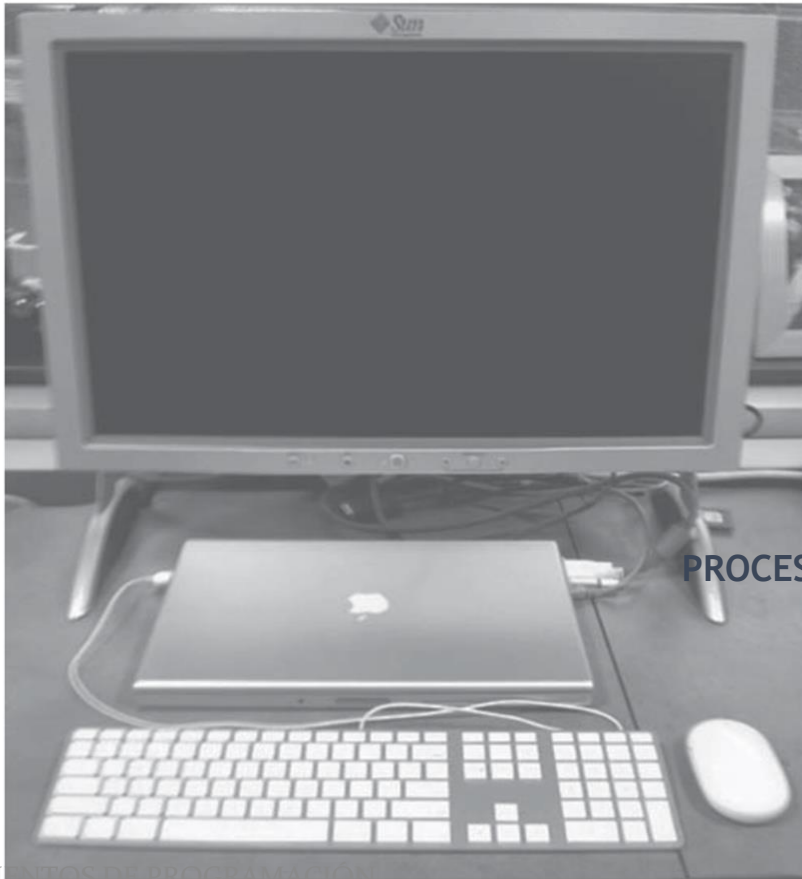
FIGURA 1.5 Un computador de sobremesa. La pantalla de cristal líquido (LCD) es el dispositivo de salida principal, y el teclado y el ratón son los dispositivos de entrada principales. En la parte derecha se puede ver un cable de Ethernet que conecta el portátil con la red y la web. El portátil tiene procesador, memoria y dispositivos de E/S. Este computador es un portátil Macbook Pro 15" conectado a un monitor externo.
