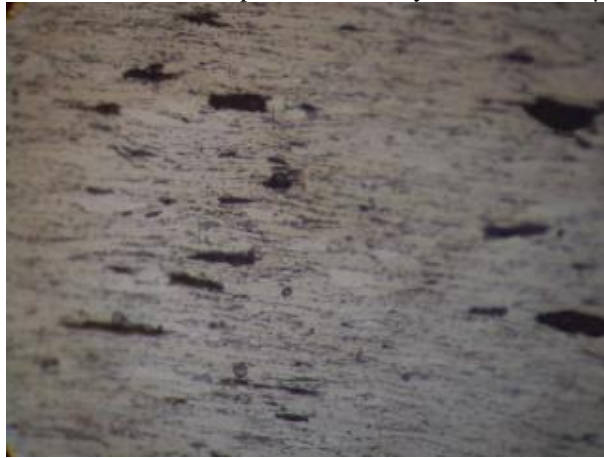
Gráfico No.12. Microestructura. Temperatura de ensayo 600°C a 100 µm de la fractura.
