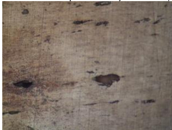
Gráfico No.13. Microestructura. Temperatura de ensayo 650°C a 100 µm de la fractura.
