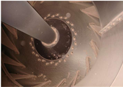
Figura 5. Fotografía del eje. Se puede observar el acople del ventilador.
