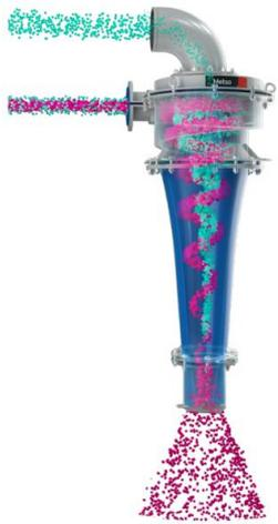
DMS hydrocyclon separa partículas con diferentes fracciones de densidad utilizando un medio con una densidad intermedia a la de las dos fracciones.
