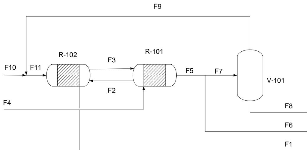
Figura 1: Proceso de producción de hierro (F1)
