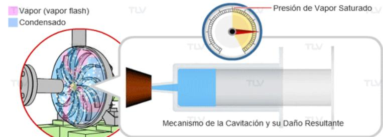
Cuando la presión del condensado cae por debajo de presión de saturación del vapor, se forman cavidades de vapor, resultando en una rotación del impulsor inestable, caída en la eficiencia de bombeo, y oscilaciones irregulares en la bomba. Estas cavidades de vapor pueden condensarse e implosionar de manera repentina, ocasionando daños al impulsor y a la carcasa de la bomba.
