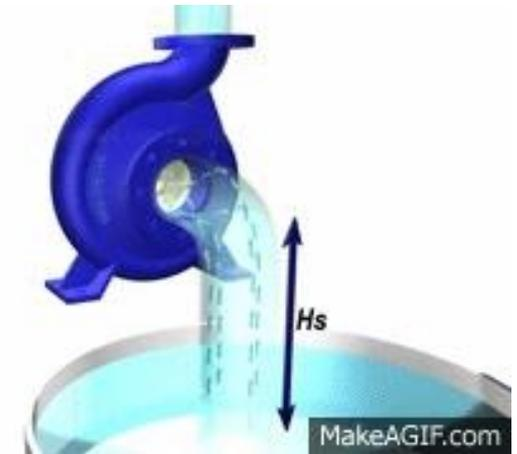
El fin práctico es poner limitaciones a las condiciones de succión de la bomba en servicio, de modo de mantener la presión en la entrada del rodete por sobre la presión de vapor del líquido bombeado; en esta condición, no habrá vaporización ni cavitación.
