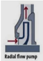
En una bomba de flujo radial, el líquido entra en el centro del impulsor y se dirige hacia afuera a lo largo de las paletas del impulsor en una dirección perpendicular al eje de la bomba.
