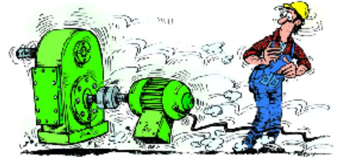
Debe ser  $NPSH_a > NPSH_r$  en todos los puntos a lo largo de la curva de la bomba
