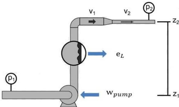
Dispositivo rotodinámico para entrega de energía  $w_{pump}$  :
