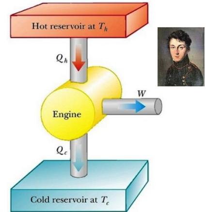
No toda la energía térmica entregada por un reservorio caliente puede ser convertida en capacidad de efectuar trabajo mecánico
