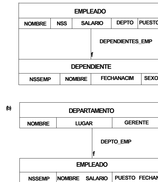
Figura 10.8 Diferentes opciones de conjuntos, (a) Tipo de conjuntos DEPENDIENTES_EMP AUTOMÁTIC FIXED. (b) Tipo de conjuntos DEPTO_EMP AUTOMÁTIC MANDATORY.
