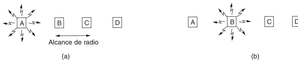
Figura 4-11. LAN inalámbrica. (a) A transmitiendo. (b) B transmitiendo.
