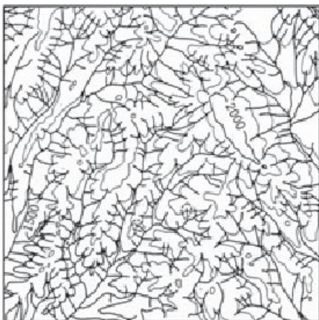
(c) Densidad de drenaje alta o de textura fina. Little Tujunga, California.
