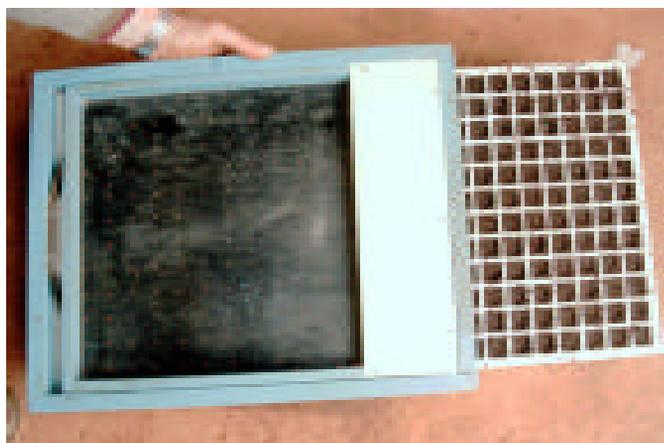
FOTO N°11: Sembradora manual de madera y plástico.
