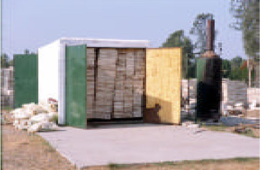
FOTO N°1: CÁMARA DE VAPOR CON BANDEJAS
