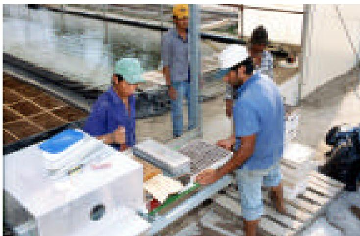
FOTO N°13: Línea automática de llenado y siembra de bandejas
