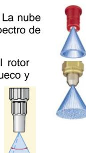
**De abanico.** Se usan básicamente para la aplicación de herbicidas porque producen gotas más grandes y menos sujetas a la deriva. El orificio de la boquilla es lenticular o alargado. La nube de aspersión es plana, en forma de un abanico
