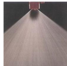
**Cono hueco.** Se utilizan especialmente para aplicar insecticidas y fungicidas. La nube de aspersión que produce forma un cono vacío en el centro. Producen un espectro de gotas mediana y pequeñas y se usan en equipos motorizados o manuales
