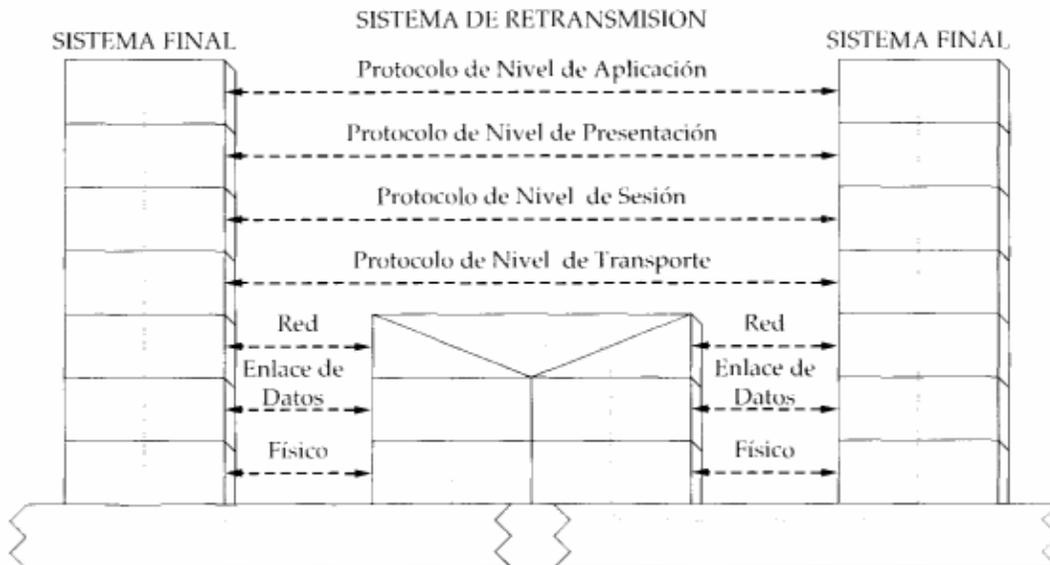
**FIGURA 12.9 Utilización de un esquema de retransmisión**
