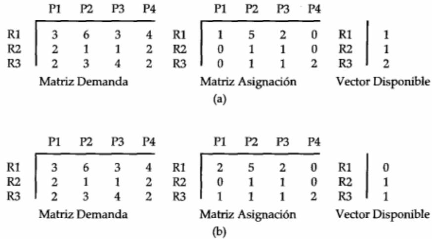
FIGURA 5.4 Determinación de un estado inseguro
