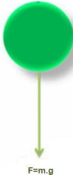
Si no se tiene en cuenta la resistencia del aire, la única fuerza que actúa es la debida a la aceleración de la gravedad.
