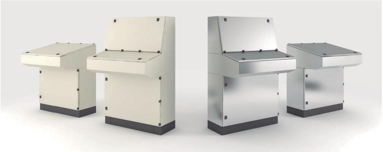
Son gabinetes con estructura autoportante de alta resistencia al impacto, indeformables, modulares y con un alto índice de estanqueidad. Construidos en chapa de acero al carbono con una terminación superficial con pintura en polvo termoconvertible color beige RAL 7032. También disponibles en acero inoxidable AISI 304.
