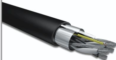
**Normas:** UL13-PLTC. No propagación al fuego IEEE383. Resistente a hidrocarburo, ASTM 1239, NFC 32-200, IRAM IAP IEC 79-14. Áreas clasificadas zona 0, sección intrínseca. Áreas clasificadas clase I div. 2 y clase II div. 2, UI2250 (ITCI50), ICEA S73-532 (300V-600V)
