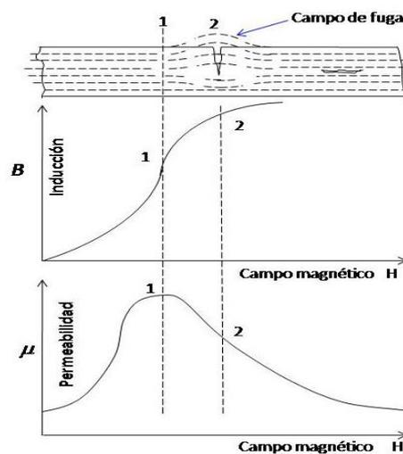
Fig. Nº 1 – Aparición de campo de fuga en presencia de una discontinuidad
