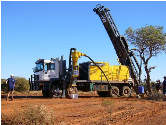
Equipo de perforación a rotación para exploración minera (Atlas Copco)
