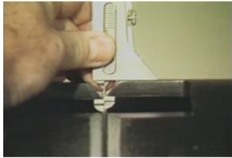
Desalineamiento (Hi-Lo) durante el ajuste
