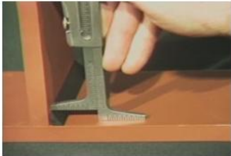
Longitud de pierna en soldaduras de filete
