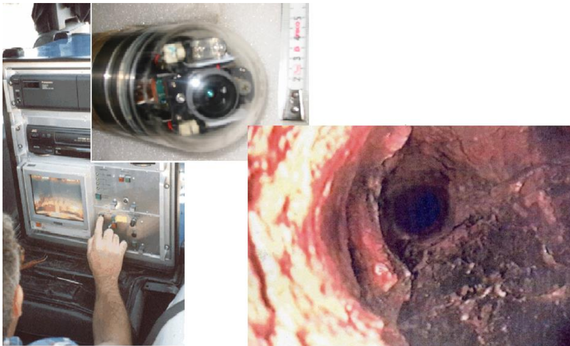
Figura 35: Cámara de TV , consola de control e imagen de una oquedad atravesada por un sondeo.
