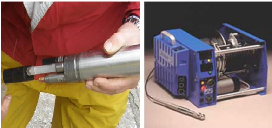
Figura 33: Sonda de calidad de agua (izquierda) y cabestrante del testificador Robertson.
