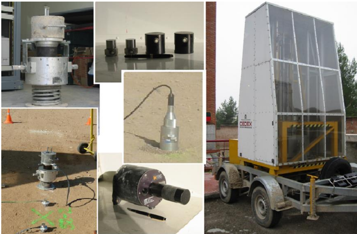
Figura 20 : Geófonos, acelerómetros y fuentes de señal utilizados en el ensayo AEOS.
