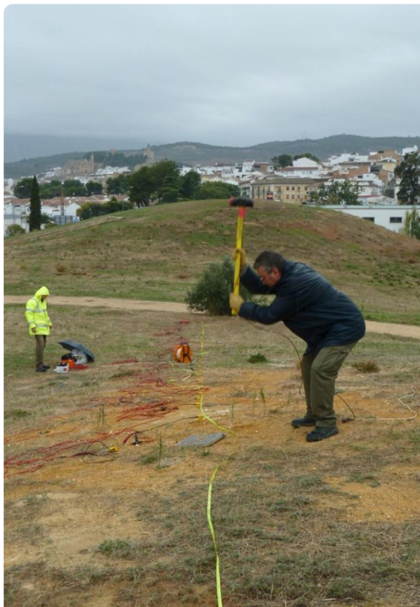
Figura 27: ejecución de un ensayo de sísmica de refracción.
