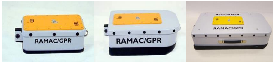
Figura 15: Antenas de 800, 500 y 250 MHz. (sin escala las dimensiones crecen según disminuye la frecuencia).
