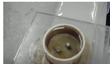
Figura 5.- Muestra con compuesto que al solidificar servirá de soporte
