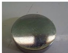
Figura 10.- Acabado especular en la probeta pulida
