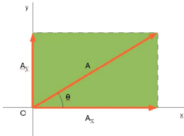
Un vector se representa gráficamente mediante una flecha cuya dirección y sentido son los del vector y cuya longitud, en una escala adecuada, es proporcional al módulo.
