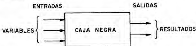
Fig. 3-39.— Simulación del problema como una caja negra con entradas y salidas únicamente.
