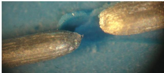
Figura 2. Fractura dúctil. Se puede observar la deformación previa a la rotura (cono y copa).
