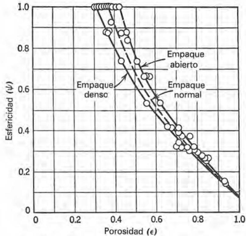
**Fig. B-12** Esfericidad en función de la porosidad para lechos de empaque aleatorio de partículas de tamaño uniforme (2). (Con permiso de John Wiley & Sons, Copyright © 1950.)
