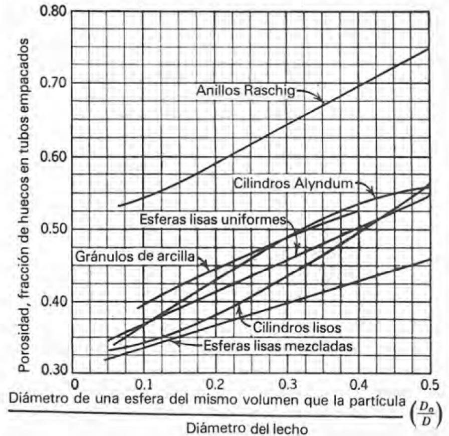
**Fig. B-13** Porosidad como una función de la relación del diámetro de partícula al diámetro del lecho (7). (Con permiso de A.I.Ch.E., copyright © 1947.)
