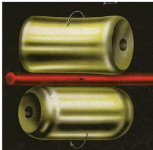
Enderezado y pulido de barras redondas de acero
