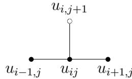
El valor  $u_{i,j+1}$  aproximación de  $u(x_i, t_{j+1})$ , pintado con bola hueca  $\circ$ , se calcula utilizando los valores para  $t_j$ , pintados con bola rellena  $\bullet$ .
