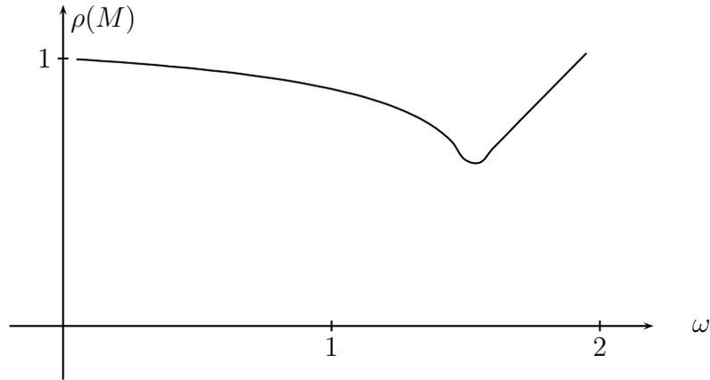
Figura 3.1: Método SOR:  $\omega$  y radio espectral
