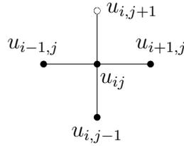
La fórmula (8.39), con error de orden  $O(h_x^2 + h_t^2)$ , se puede aplicar fácilmente, salvo para la obtención de los valores  $u_{i1}$  ya que sería necesario conocer los valores  $u_{i,-1}$ . Aproximaciones de estos valores se obtienen utilizando las condiciones (8.37) sobre la velocidad inicial, mediante la siguiente aproximación cuyo error es del orden de  $O(h_t^2)$ ,
