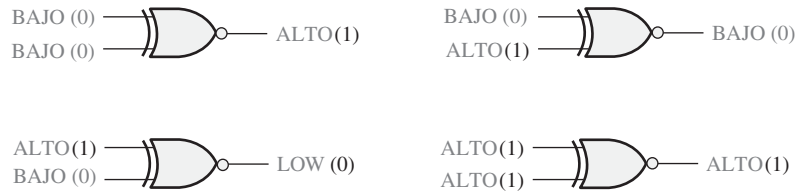
FIGURA 3.45 Todos los niveles lógicos posibles para una puerta NOR-exclusiva.
