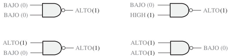
FIGURA 3.26 Funcionamiento de la puerta NAND de 2 entradas.
