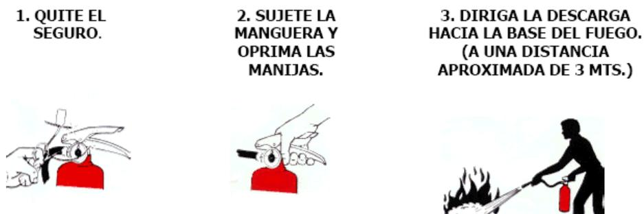
Fig.02 procedimiento para el uso de extinguidores.
