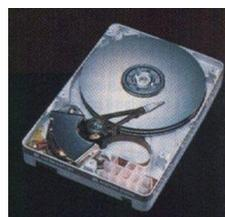
Son otro de los elementos habituales en los ordenadores, al menos desde los tiempos del 286. Un disco duro está compuesto de numerosos discos de material sensible a los campos magnéticos, apilados unos sobre otros; en realidad se parece mucho a una pila de disquetes sin sus fundas y con el mecanismo de giro y el brazo lector incluido en la carcasa. Los discos duros han evolucionado mucho desde los modelos primitivos de 10 ó 20 MB.
