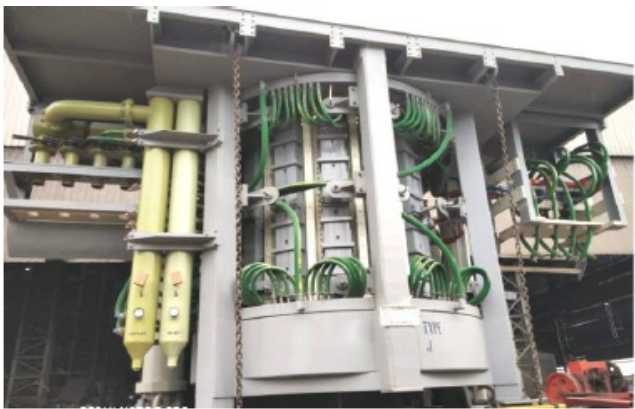
El diseño eléctrico de alta eficiencia permite un ahorro de energía combinada de entre 15 y 20 kWh/t.
