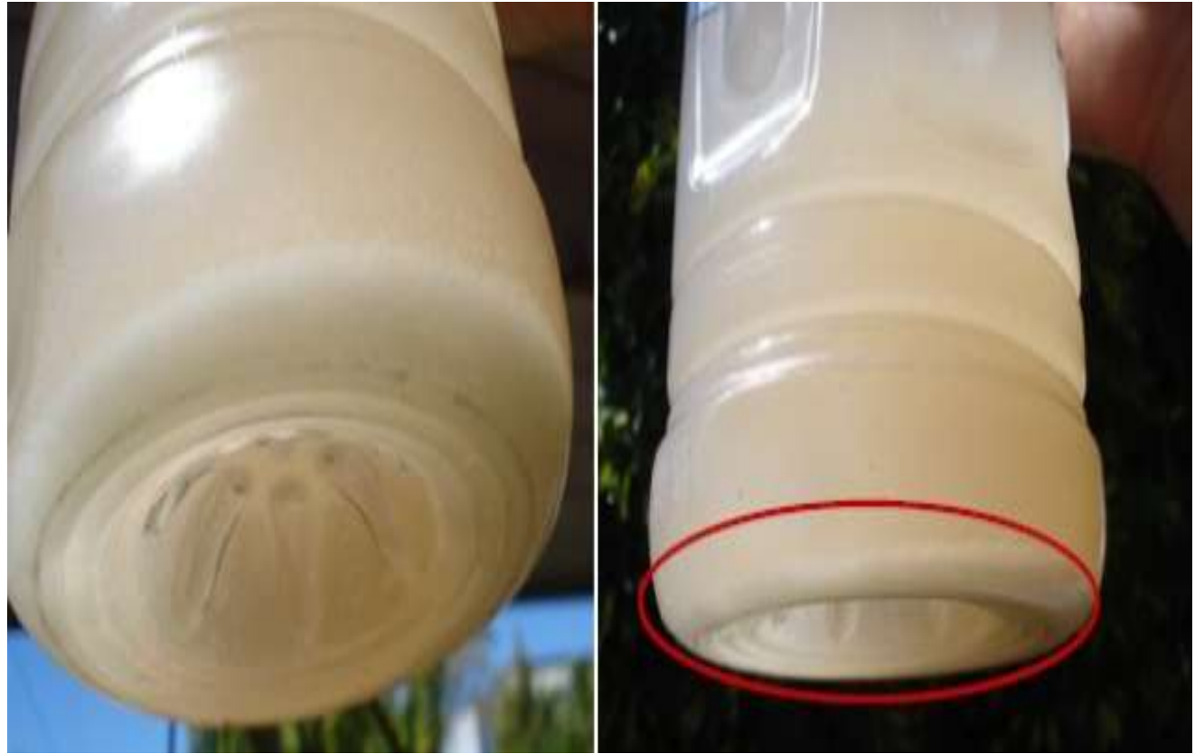
Figura 2. Glifosato sal potásica con sedimento de 5 mm en los bordes del recipiente.
