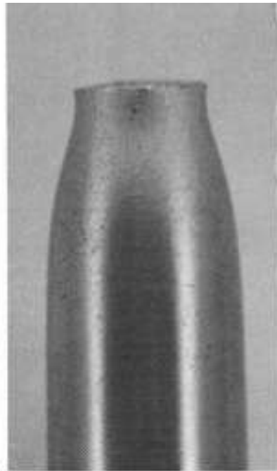
Fractura dúctil copa-cono en el aluminio
