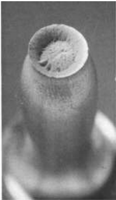
Fractura dúctil copa-cono en el aluminio
