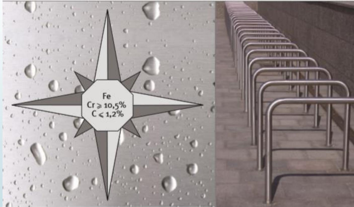
Es una aleación de hierro con un contenido de cromo  $> 10,5\%$  y de carbono  $< 1,2\%$ , necesario para asegurar una capa protectora superficial autorregenerable (capa pasiva) que proporcione la resistencia a la corrosión.
