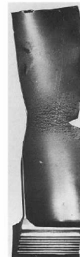
Agrietamiento por "Creep" de un álabe de turbina de Gas.
