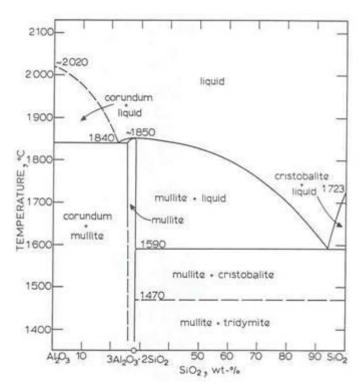
A partir del trabajo de De Aza - Cavallieri su estequiometría corresponde a la relación Al<sub>2</sub>O<sub>3</sub>/SiO<sub>2</sub> igual a 3/2 (71,8 % de Al<sub>2</sub>O<sub>3</sub>) y dicha mullita no presenta solución sólida con la SiO<sub>2</sub> pero si presenta solución sólida con la alúmina hasta contenidos del 74,3 %. Pese a su estabilidad, su existencia en la naturaleza es rara y no se conocen yacimientos explotables.
