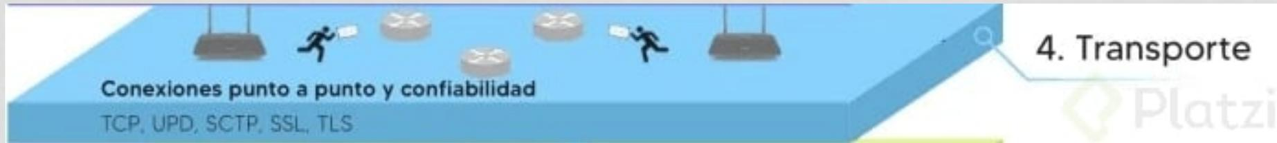
Esta [capa de transporte](#) tiene el objetivo de **garantizar que los datos se entreguen de manera confiable y en el orden correcto**. Agrega control de flujo y comprobación de errores para garantizar que los datos no se pierdan ni se corrompan durante la transmisión. Se encuentran protocolos como TCP.
