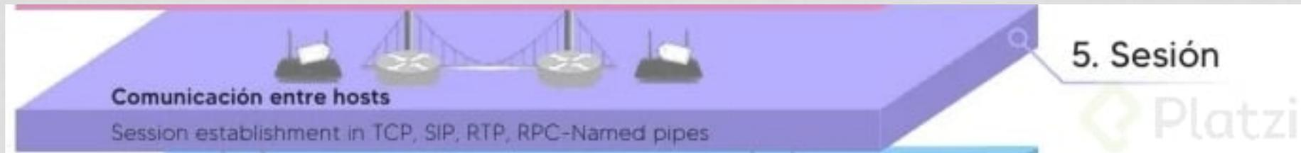
Después, la [capa de sesión](#) tiene como fin **establecer, mantener y terminar las conexiones entre dispositivos**. Permite que los dispositivos se comuniquen entre sí y coordinen sus actividades. Entre sus funciones está:
