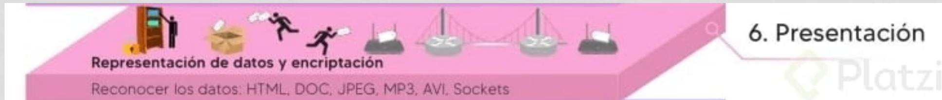
Esta [capa de presentación](#) es responsable de **convertir los datos a un formato que pueda ser entendido por el dispositivo receptor**. También maneja el cifrado y la compresión de datos para garantizar que se transmitan de manera segura y eficiente. Formatea los datos para transferirlos a la siguiente capa.
