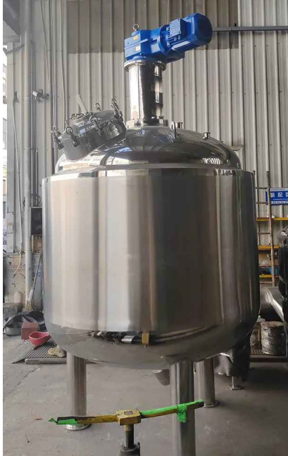
Figura 2. RTAC de polimerización en masa por radicales libres.
