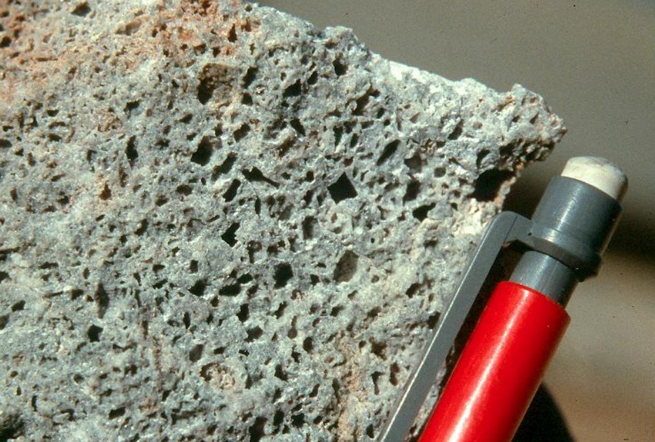
Alteración a sílice oquerosa o residual (vuggy silica) de un pórfido , Distrito El Indio
