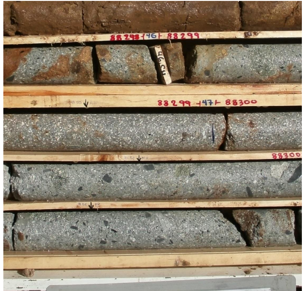
Tobas lapillíticas de Chinchillas Resalta una tonalidad gris plomiza a azulina cuando el Kfsp está preservado
