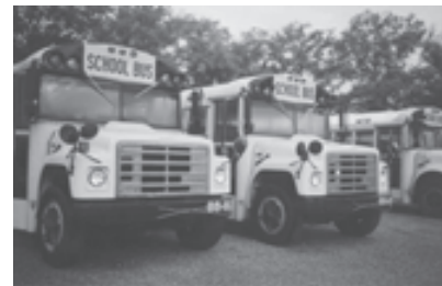
Estos camiones escolares tienen un anillo de cable en el parachoques el cual se extiende hacia fuera para asegurar que no haya niños ocultos bajo el cofre.
