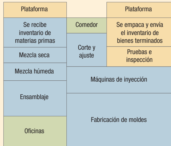
FIGURA 4.11 | Plano general de la planta
