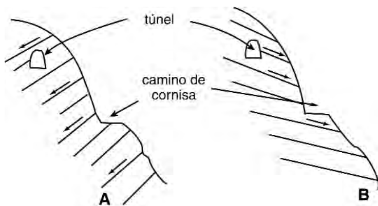
Figura 218. Casos A y B de condiciones favorable y desfavorable respectivamente en la construcción de túneles y caminos de montaña.
