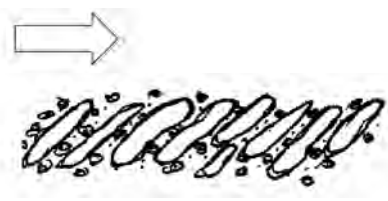
Figura 152. Clastos imbricados por los efectos de un flujo torrentoso. El sentido de la corriente que imbricó a estos clastos es hacia la derecha.
